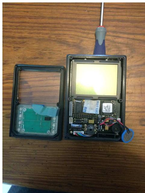
Voilà, il ne reste plus qu'à retirer la prise (en tirant doucement) pour dessouder et souder plus facilement. La batterie côté plus :
