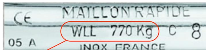
WLL = **W**orking **L**oad **L**imit (770 Kg X facteur de sécurité 5 = 3850 Kg pour un maillon d'un Ø de 8 mm ce qui respecte la norme et d'avantage.
