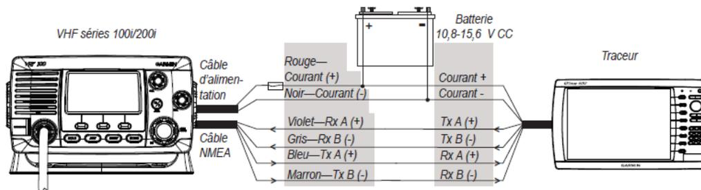
**ATTENTION :** recouvrez les connexions de ruban adhésif étanche à base de caoutchouc vulcanisé afin d'éviter que de l'eau ne s'introduise dans la VHF.
