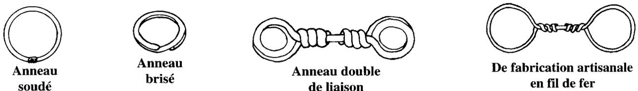
Les émerillons se fixent facilement avec des boucles de liaison ou les noeuds qui sont expliqués à la section 3G. Dans la mesure du possible, il vaut mieux faire des liaisons permanentes, avec des noeuds par exemple. N'utilisez les boucles de liaison et les émerillons à agrafe que lorsque vous avez besoin de monter et de démonter la ligne fréquemment (par exemple pour changer les bas de ligne).
