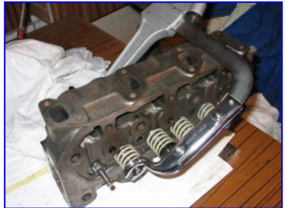
Après nettoyage des gorges de pistons , remplacement des segments . Compte de tenu du bon état apparent de l'ensemble je n'ai fait aucune mesure de vérification .
