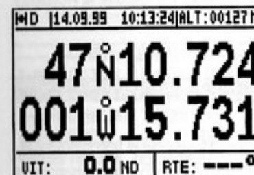
Note 1 : la lettre D s'affiche en haut à gauche dans les écrans de fonction lorsque le FX412 calcule sa position en mode différentiel. L'indication de précision ECP prend automatiquement en compte la précision du mode différentiel.
