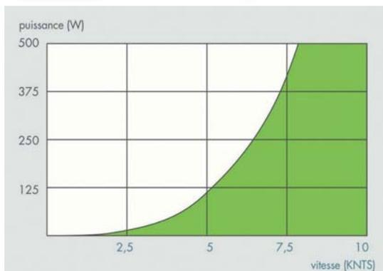
10 heures à 5 nœuds et 3 heures à 8 nœuds pour recharger un parc de batteries 12V de 200 Ah à 50% de sa capacité !
