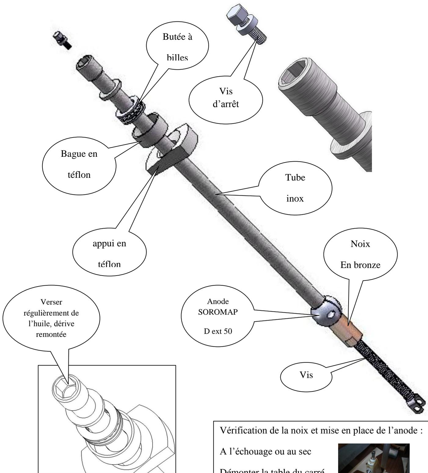
Vérification de la noix et mise en place de l'anode :
