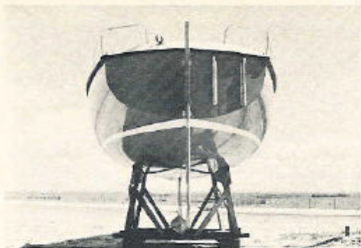
On note sous cet angle la longueur du safran et le contraste entre sa finesse, ainsi que celle de l'ailleron de quille, et les volumes généreux de la coque.
