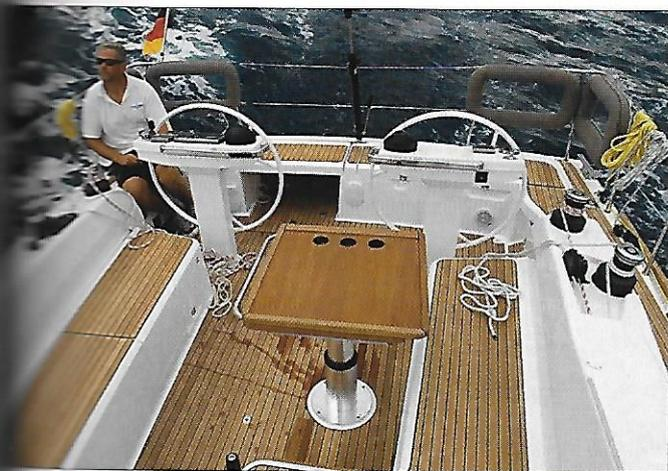
▲ La position très reculée des winches permet au barreur de se saisir directement des manœuvres.
