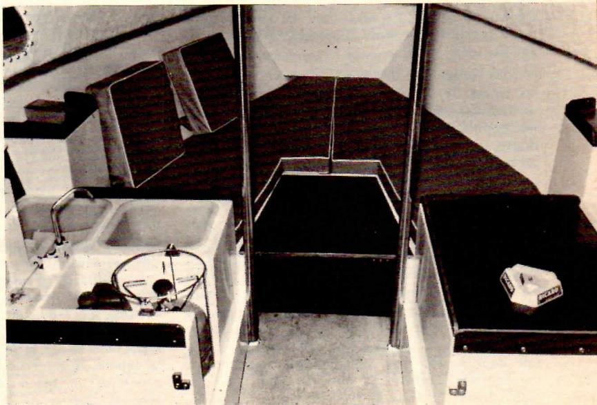
Le poste avant avec à tribord la table de travail et de navigation qui forme un vaste coffre pouvant être aménagé en glacière; à bâbord le bloc cuisine. Le wc marin est dissimulé entre deux couchettes avant.
