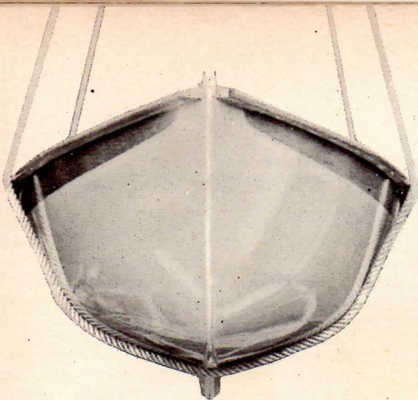
sente comme un dériveur lesté possédant un court aileron qui supporte 70 kg de fonte. La dérive s'escamotant partiellement au sein de cet aileron, il est d'ailleurs devenu possible de réduire la hauteur du puits de dérive du Flibustier au profit de l'habitabilité.
