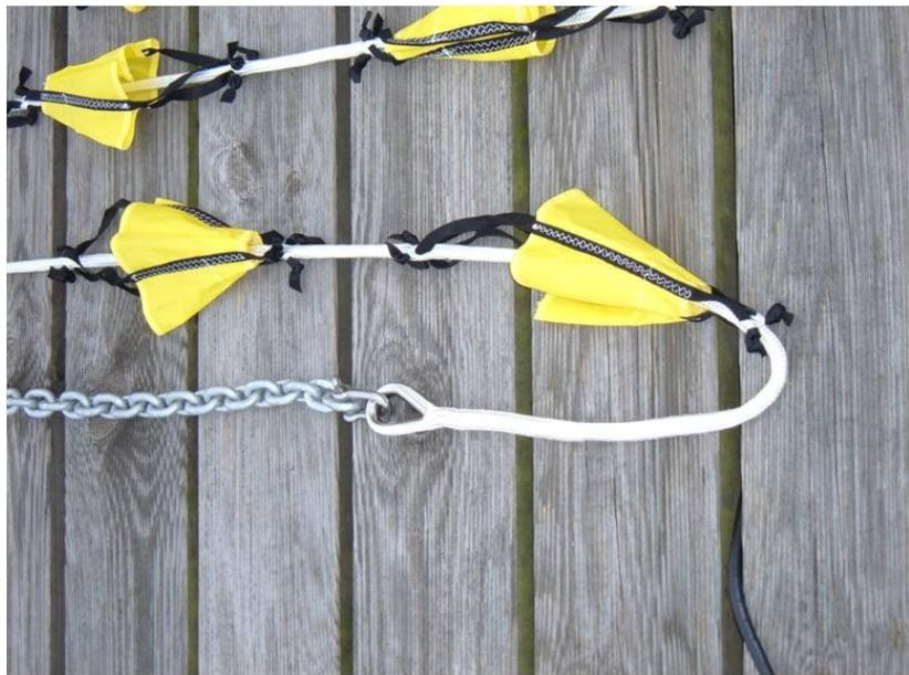
Le nombre de cônes dépend du déplacement du bateau. Un poids est fixé à l'extrémité de l'aussière pour que le système reste immergé et en tension.
