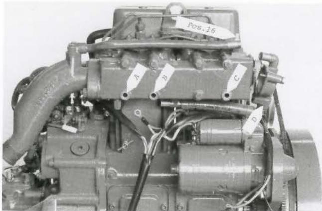
Demontera bultarna A, B och C på avgaslimpans nedre bultrad. Demontera termostathuset D. Byt termostaten och temperaturgivaren Pos 16 mot de ur satsen.
