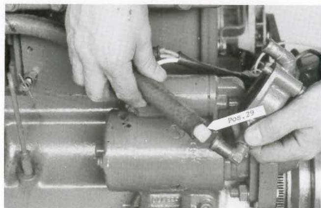
Innan termostaten återmonteras, stoppa in plastpluggen Pos 29 i slangens under avgaslimpan vid termostathuset. Återmontera termos-
