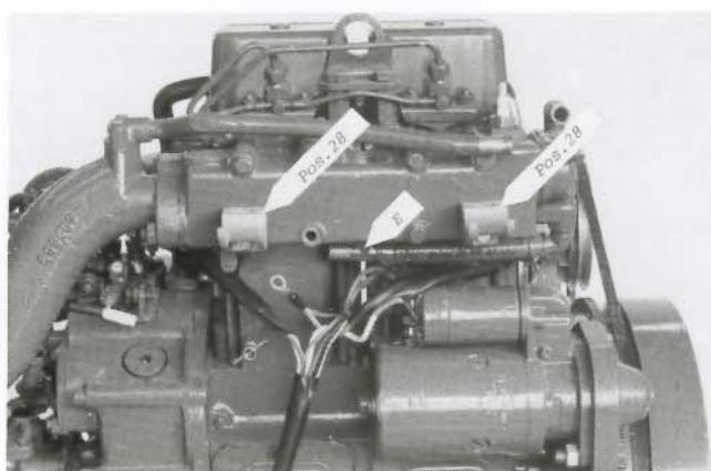
Lossa sjövattenpumpens slang (rör) vid T-stycket E under avgaslim-
