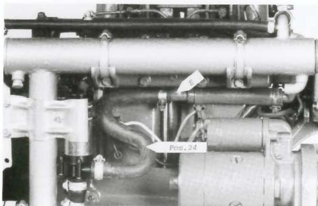
Träd på de monterade slangarna på termostathuset och avgaskröken och lägg värmeväxlaren i MS 101 fästen (se bild). Öppna slangklamrnorna SMS 56 Pos 27, träd in slangklamrnorna i skårorna på MS 101-fästena och slut den kring värmeväxlaren. Skruva några varv för hand på klamman så den tar "gång" innan mejsel används. Fixera värmeväxlaren i lod. Efterdrag M8 bultarna till MS 101-fästena samt slangklamrnorna.
