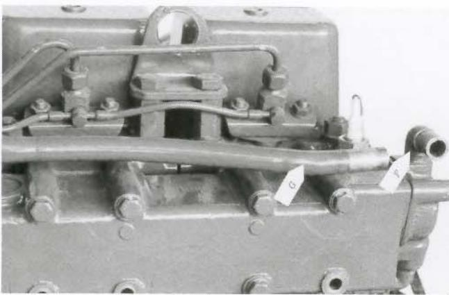
F. Vrid termostathusets övre 90° slanganslutning 90° mot SB. Böj ut och ner vattenrör G på avgaskröken så att röret går emot den främre övre bultskallen på avgaslimpan (se bild).
