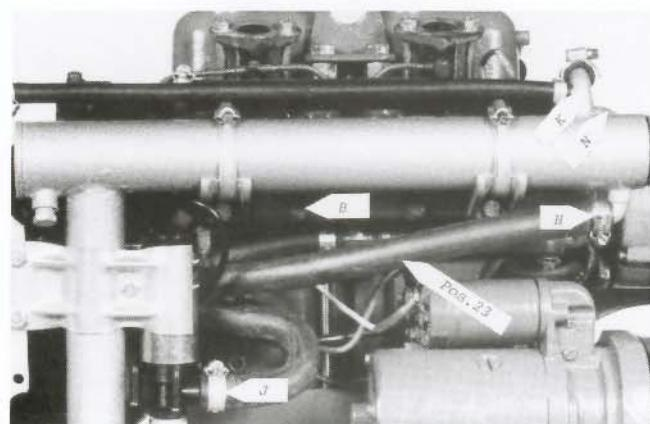
Återmontera bult B på avgaslimpan med motorns elhärla och elpum-
