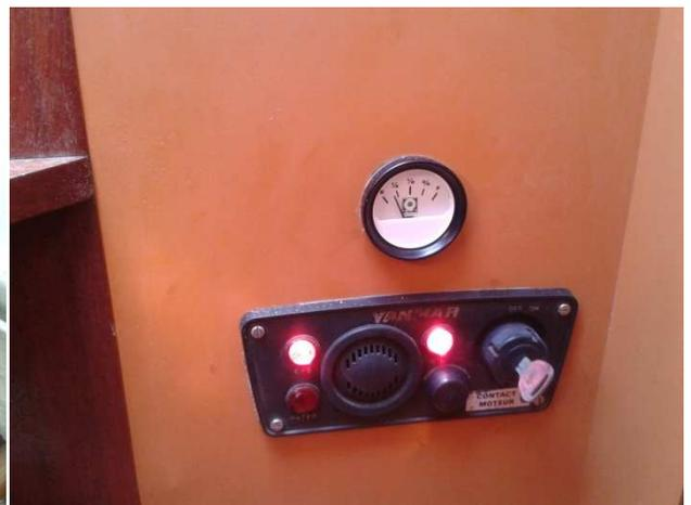
*Montage du nouveau réservoir bloqué en place par un système de sangle et ajout d'une jauge à carburant. La réglette qui me servait de jauge ne pouvant plus pénétrer dans le nouveau réservoir. Dommage, ce système était de loin le plus efficace.*
