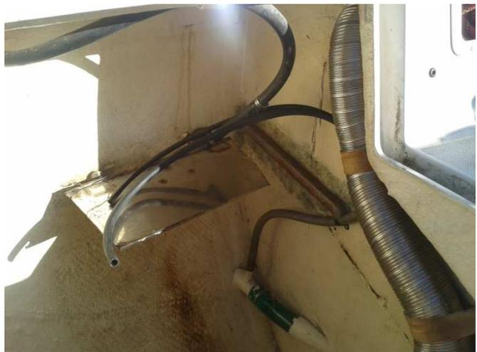
*Puis, stratification d'un tasseau en bois sur le coté du coffre pour permettre l'assise d'un socle en contreplaqué.*
