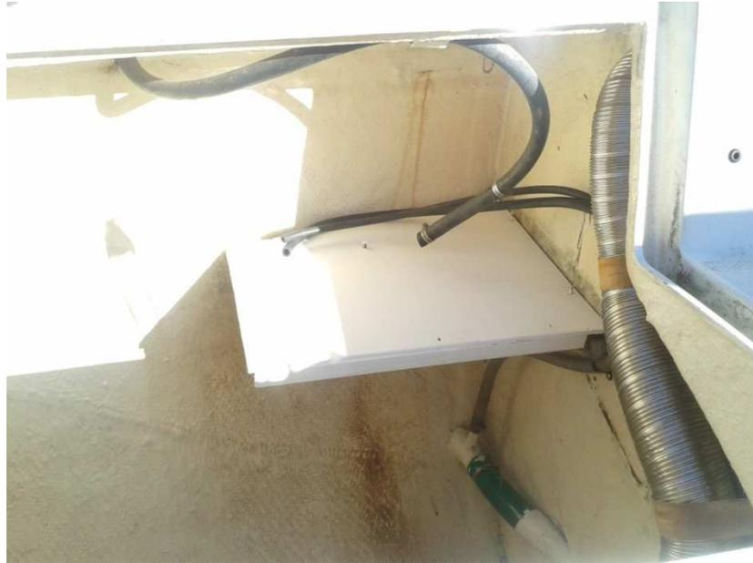
*J'en profite pour remplacer toutes les durites en cuivre datant de la construction du bateau, par de la durite souple*
