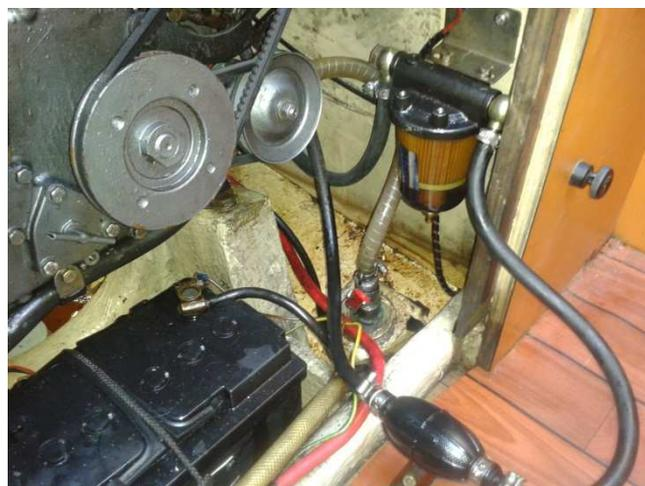
*Le pompage du gasoil se faisant maintenant par le dessus du réservoir j'ai ajouté une poire de réamorçage type nourrice entre le pré filtre et le filtre moteur afin de faciliter le redémarrage du moteur après un désamorçage.*
