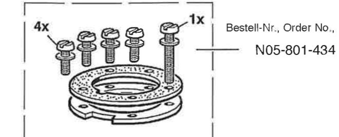
Einbau-Ø / Installation Dia.: 59 mm
