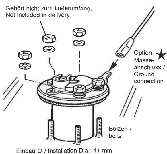
Einbau-Ø / Installation Dia.: 41 mm
