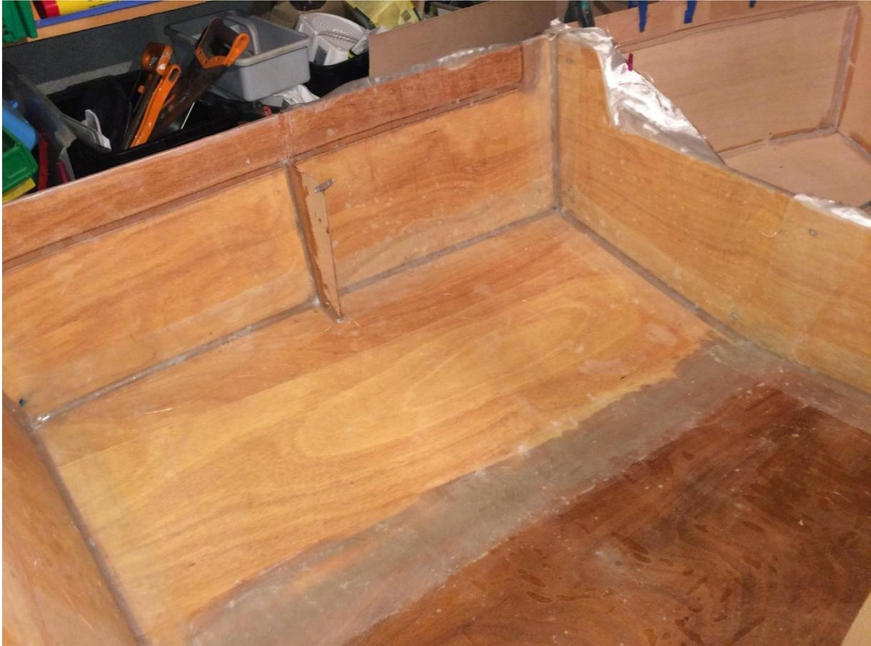
A noter que j'ai « doublé » la partie haute du bordé sur 10cm, pour rigidifier le bordé. Il fait donc 10mm à cet endroit. J'ai aussi positionné une petite « cloison » au milieu du bordé arrière. Elle rigidifie le bordé et sera l'avant du coffre arrière.
