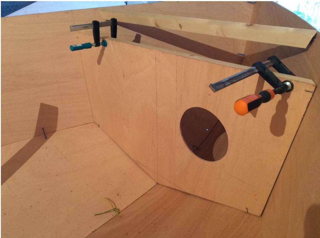
Y'a plus qu'à coller tout ça ! J'ai préparé un mastic epoxy (résine epoxy et poussière de bois woodfil), et mis des petits joints congés entre les morceaux de fil électrique :
