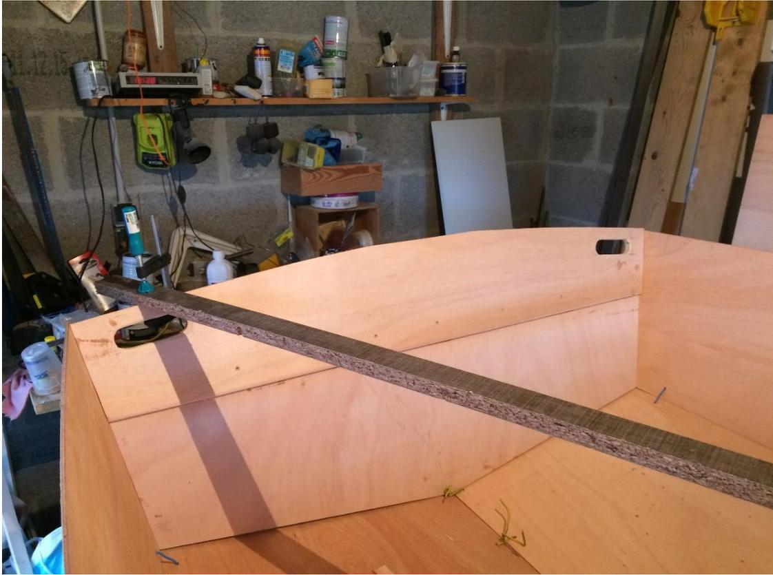
J'ai ensuite réalisé les 2 cloisons du milieu. Je les ai vissés ensemble et séparées par une cale de 3mm pour pouvoir y passer une lame de scie lorsque la découpe sera réalisée :
