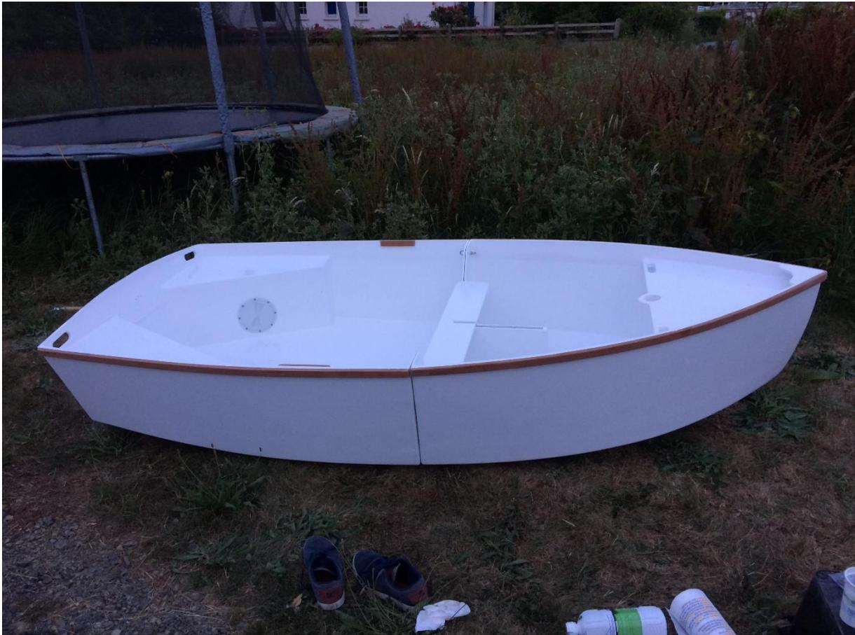
C'est un voile aviron de 2,80 m de long, sur 1,40m de large, démontable en 2 parties, avec l'avant qui se range dans l'arrière. Les 2 parties sont simplement boulonnées entre elles par les cloisons du milieu (faisant ainsi 2 demi-fripouillettes), avec un petit joint d'étanchéité (simple bout de chambre à air)
