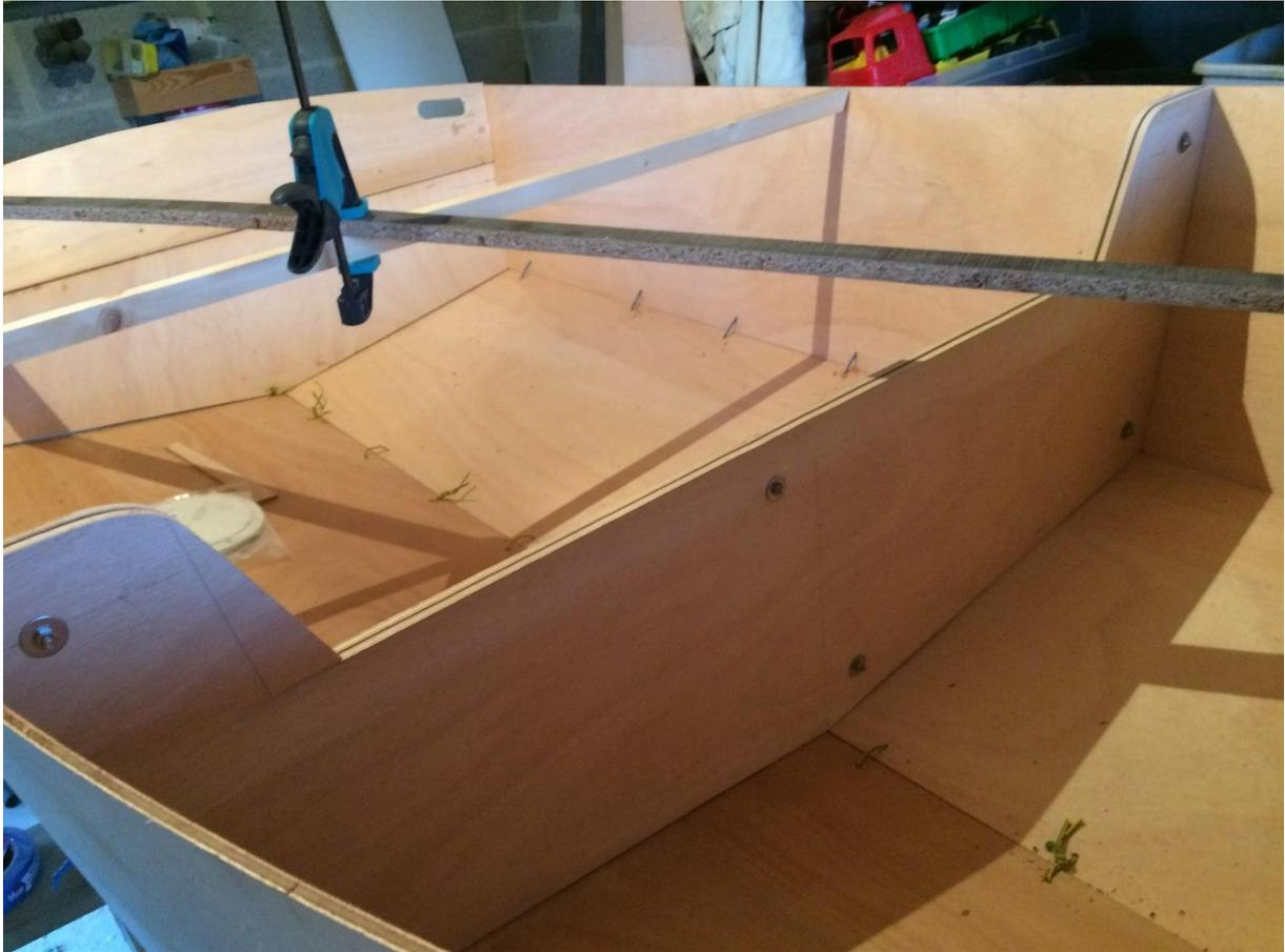
Et la cloison avant, avec le trou qui recevra une trappe :
