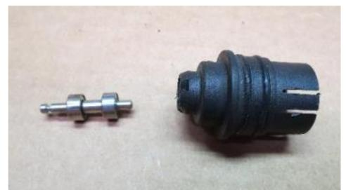
L'arbre aura probablement de la saleté/débris/rouille sur la surface, j'ai donc jeté l'arbre en utilisant la zone centrale où les roulements ne roulent pas avec ma perceuse à batterie. En tenant la toile émeri ou le papier de verre super fin, j'ai nettoyé les deux extrémités de l'arbre.
