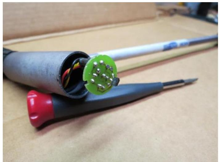
Cette image de gauche ci-dessus montre le tournevis serré en place pour pousser sur la languette. Pour plus de clarté, j'ai pris cette photo après avoir retiré le circuit imprimé.
