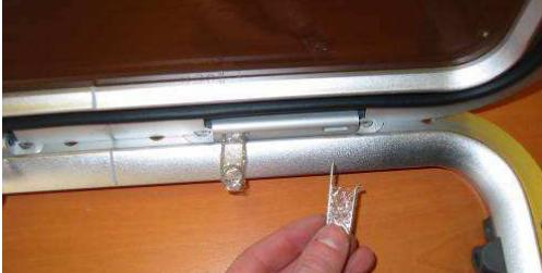
Les épingle ressort peuvent être conservées afin de procéder au démontage ultérieur de l'ouvrant.
