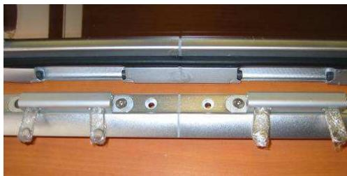
Retirer les épingle ressort les unes après les autres et soulever légèrement l'ouvrant pour engager les axes de charnières dans l'ouvrant.
