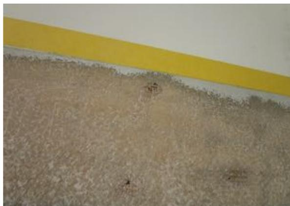
Alberto nos explica que han propuesto una tela de 600 gramos porque corresponde al espesor disponible a lo largo de la línea de flotación. En caso de poner mas telas, y por tanto mayor espesor, el casco quedaría con un escalón en la línea de flotación, por lo que para dejar la laminación nueva nivelada, tendrían que seguir quitando el gelcoat de los costados hasta llegar a una zona que permitiese un solapado entre nuevo y viejo nivelado, lo que encarecería notablemente la reparación.
